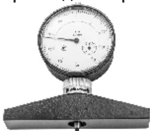
Глубиномеры индикаторные типа ГИ предназначены для измерения глубины пазов, отверстий и высоты уступов. Диапазон измерения обеспечивают набор сменных измерительных стержней, оснащенных твердым сплавом. Отсчет - по индикатору.
