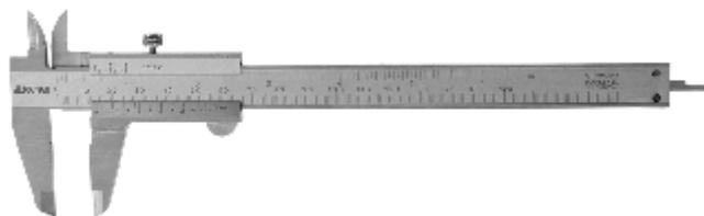
Штангенциркули типа ШЦ-1 Pro характеризуются повышенным качеством исполнения и большей долговечностью. Рекомендуются пользователям, предъявляющим повышенные требования к качеству измерений. Нержавеющая сталь. Наружные и внутренние губки, встроенный глубиномер. Двухсторонняя шкала.
