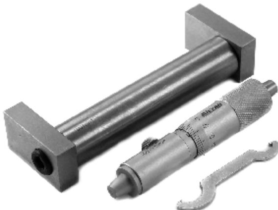
Нутромеры микрометрические узкодиапазонные типа НМ-У предназначены для измерения внутренних размеров изделий. В отличии от обычных микрометрических нутромеров, настраиваемых на необходимый диапазон с помощью соответствующих удлинителей, исполнение данных - штучное. Отсчет производится по шкалам стебля и барабана микрометрической головки. Измерительные поверхности притёрты по сфере. В комплект входит установочная мера.
