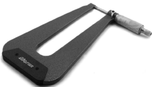
Микрометры листовые типа МЛ предназначены для измерения толщины листов и лент. Показания считываются по шкалам стебля и барабана измерительной головки. Измерительные поверхности пяток плоские. У микрометров МЛУ вылет скобы 150 мм (увеличенный).
