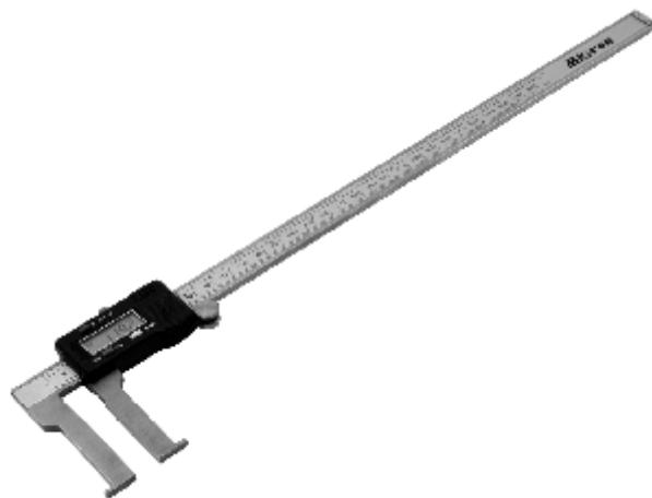
Штангенциркули типа ШЦЦ-ВК с цифровым отсчетом (электронные) специальные предназначены для измерения труднодоступных внутренних канавок и проточек. Прибор имеет возможность установки «0» в любой позиции, переключение на метрическую или дюймовую систему.
