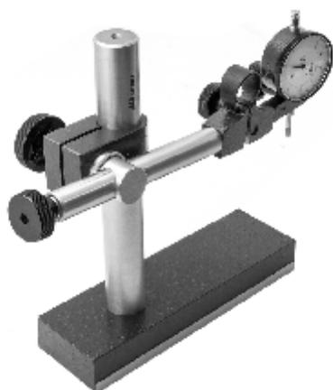
Штативы типа Ш предназначены для установки на них измерительных головок с ценой деления 0,01 мм (для штатива Ш-III - 0,01 мм и более).
