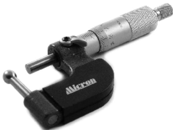
Микрометрами трубными типа МТ измеряют толщину стенок труб. Измерительная поверхность пятки выполнена в виде стержня со сферой, диаметром 4,7 мм, расположенного перпендикулярно перемещению стебля микрометрической головки. Измерительные поверхности оснащены твердым сплавом.
