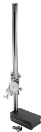
Штангенрейсмасы типа ШРК предназначены для выполнения измерений и разметки различных деталей в машиностроении. Штанга прибора имеет миллиметровую шкалу. Отсчет показаний производится по круговой шкале индикатора. Оснащены устройством тонкой подачи. Сменная измерительная/разметочная ножка оснащена твердым сплавом.
