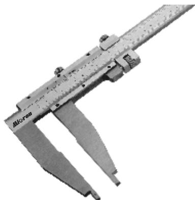
Штангенциркули с отсчетом по нониусу типа ШЦ-3 предназначены для наружных и внутренних измерений. Имеют устройство тонкой подачи. Имеют двойную шкалу: в миллиметрах и дюймах. Имеют губки с плоскими и цилиндрическими измерительными поверхностями для измерения наружных и внутренних размеров соответственно. Длина основных губок может быть разной в зависимости от модификации.
