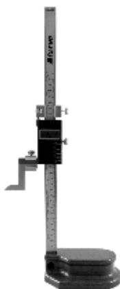
Штангенирмасы типа ШРЦ предназначены для выполнения измерений и разметки различных деталей в машиностроении. Штанга прибора имеет миллиметровую шкалу. Отсчет показаний производится по электронному цифровому индикатору. Оснащены устройством тонкой подачи. Сменная измерительная/разметочная ножка оснащена твердым сплавом.
