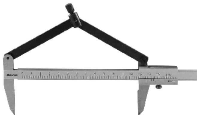
Штангенциркули разметочные типа ШЦР предназначены для проведения разметочных работ на различных поверхностях. Оснащены удобной циркульной системой развода губок. Губки закаленные или с твердосплавными напайками.
