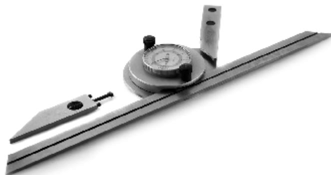
Угломер со стрелочной круговой шкалой предназначен для измерения наружных и внутренних углов. Диапазон измерения: -наружных углов 0-360° (4x90°), -внутренних углов 0-270°.
