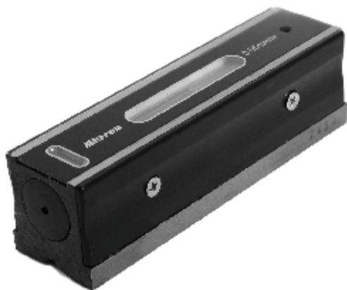
Уровни брусковые предназначены для контроля горизонтального расположения поверхностей, а также прямолинейности и плоскостности горизонтально расположенных плоских и цилиндрических поверхностей с высокой точностью. Отсчет - по штрихам ампулы. Устройство выставления на ноль. Опорная поверхность изготовлена в виде призмы.
