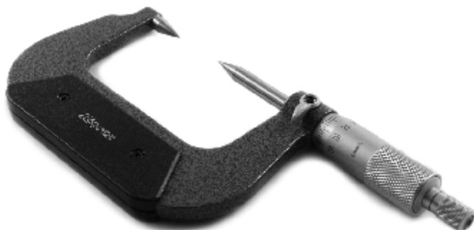
Микрометры с точечными измерительными поверхностями типа МК-ТП предназначены для измерения пазов и шлицев, шпоночных канавок, имеющих угловую форму, и других труднодоступных для измерения мест (измерение толщины втулки с внутренней резьбой). Особенно подходят для измерения мелких деталей благодаря малым измерительным поверхностям. Измерительные поверхности микрометра сужаются под углом 30° до толщины 0,3 мм, оснащены твердым сплавом.
