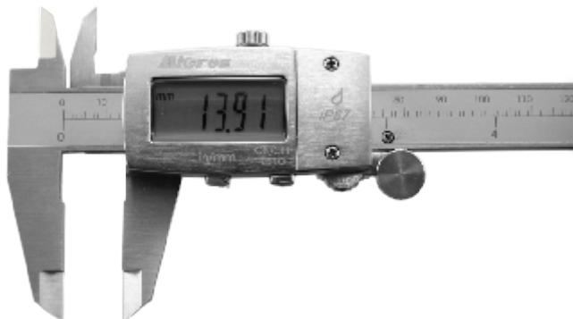
Штангенциркули ШЦЦ-1 Pro предназначены для особенно требовательных заказчиков, использующих инструмент в экстремальных условиях. Он имеет защитное исполнение, предохраняющее инструмент от воздействия среды. IP65 предотвращает проникновение пыли, металлических частиц, капель воды или СОЖ внутрь электронного блока благодаря эффективной инкапсуляции основных элементов. Цифровой блок предоставляет возможность установки нуля в любом положении и выбора системы исчисления мм/дюйм.
