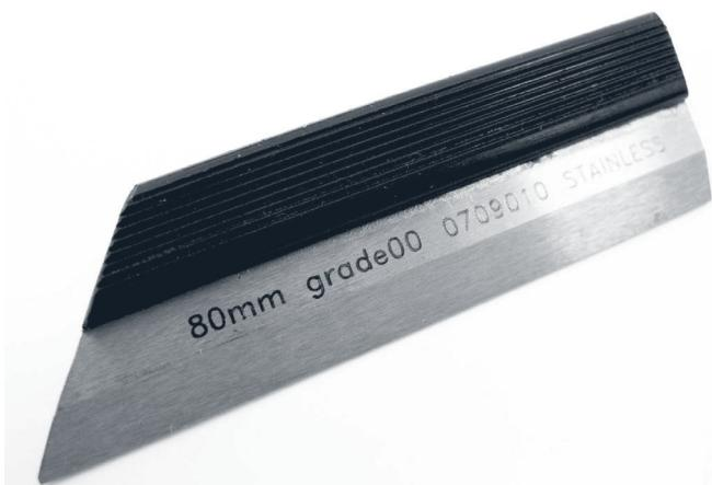
Линейки поверочные лекальные с двусторонним скосом типа ЛД применяются для проверки плоских поверхностей методом световой щели - на просвет, непосредственно определяемый на глаз, либо сравнением с образцом просвета, а так же методом определения линейных отклонений при помощи линейки и плиток, щупов или плиток в сочетании с рычажным индикатором. Снабжены термоизоляционной накладкой.
