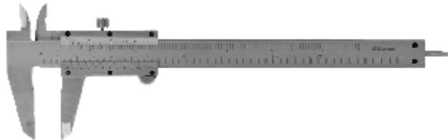
Штангенциркули с отсчетом по нониусу типа ШЦ-1 предназначены для наружных и внутренних измерений, а также для измерения глубин. Имеют двойную шкалу: в миллиметрах и дюймах. Имеют губки наружные для измерения наружных размеров и кромочные для измерения внутренних размеров, а также встроенный глубиномер. Нониус регулируемый. Длина губок стандартная.
