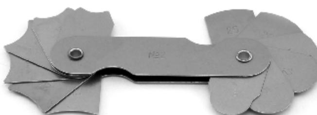
Шаблоны радиусные предназначены для оценки радиусов выпуклых и вогнутых поверхностей. Изготавливаются три набора радиусных шаблонов. В каждом наборе скомплектованы шаблоны для контроля наружного и внутреннего радиусов. Конструкция обоймы набора обеспечивает возможность свободной замены любого шаблона, а также регулирование плавности вращения их на оси.
