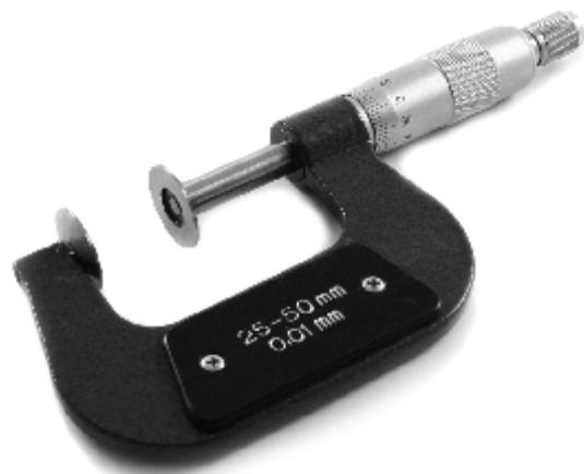
Микрометры зубомерные типа МЗ предназначены для измерения длины общей нормали зубчатых колес с модулем от 1 мм. Микрометры с верхним пределом измерений 50 и более укомплектованы установочной мерой.
