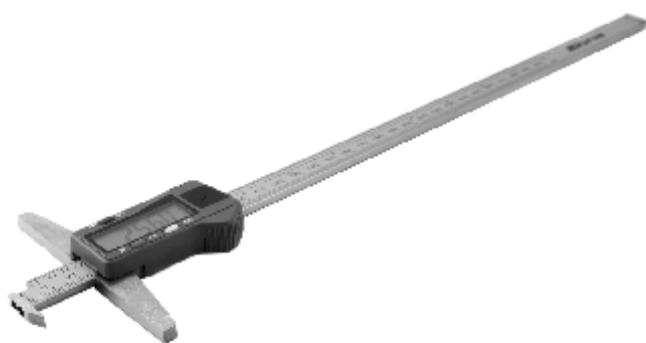
Штангенглубиномером типа ШГЦС можно производить измерения расположения труднодоступных канавок, других толщин, невозможные ординарным инструментарием. Отсчет показаний осуществляется по цифровой шкале. Цифровой блок позволяет устанавливать ноль в любом положении.
