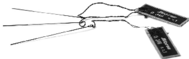
Проволочки и ролики применяются для измерения среднего диаметра наружной резьбы, а также измерения толщины зубьев и ширины впадин шлицевых валов и втулок с эвольвентным профилем. Предназначены для контроля среднего диаметра резьбы методом трех проволочек. Диаметр проволочек и роликов Вы можете подобрать из предлагаемого ряда или заказать уникальный диаметр для Ваших нужд.
