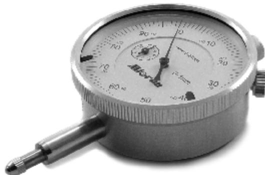
Индикатор часового типа с диапазоном измерения от 0 до 1 мм. Цена деления 0,001 мм. Позволяет выполнить специальные высокоточные измерения при использовании обычных для ИЧ способов крепления.
