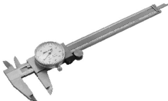
Штангенциркули с отсчетом по круговому стрелочному индикатору типа ШЦК-1 предназначены для наружных и внутренних измерений, а также для измерения глубин. Незаменимы для выполнения некоторых задач измерения. Индикаторная шкала позволяет регулировать установку на ноль, контролировать допусковые отклонения. Имеют наружные губки для измерения наружных размеров и внутренние для измерения внутренних, а также встроенный глубиномер.
