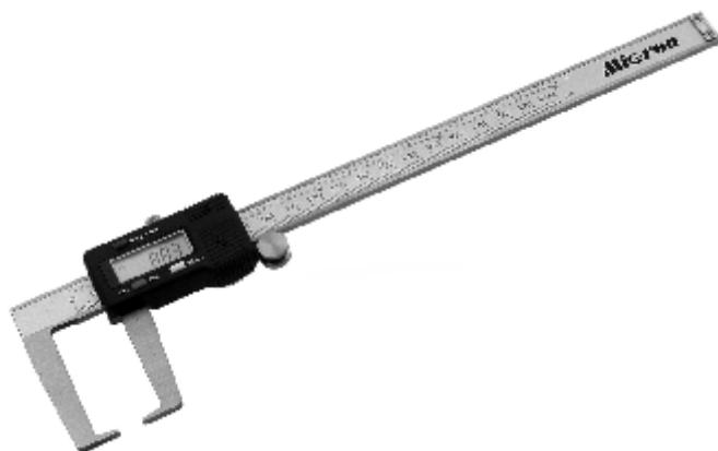
Штангенциркули типа ШЦЦ-НК с цифровым отсчетом (электронные) специальные предназначены для измерения труднодоступных наружных канавок и проточек. Прибор имеет возможность установки «0» в любой позиции, переключение на метрическую или дюймовую систему.
