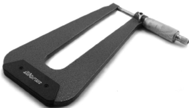
Микрометры листовые типа МЛ предназначены для измерения толщины листов и лент. Показания считаются по шкалам стебля и барабана измерительной головки. Измерительные поверхности пяток плоские. У микрометров МЛУ вылет скобы 150 мм (увеличенный).
