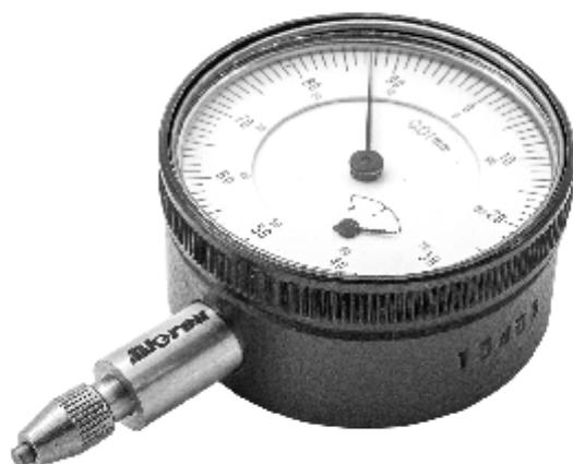
Индикаторы часового типа ИЧ с ценой деления 0,01 мм (далее – индикаторы) предназначены для измерения линейных размеров абсолютным и относительным методами, определения величины отклонений от заданной геометрической формы и взаимного расположения поверхностей. Физическая величина – длина (мм).
