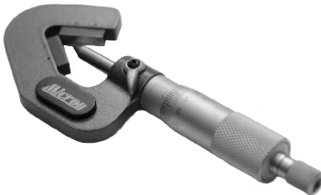
Призматические микрометры служат для измерения наружного диаметра многолезвийного инструмента, а именно: модель МТИ с углом призмы  $60^\circ$  - для трехлезвийного инструмента. В комплект микрометра входит установочная мера. Измерительные поверхности оснащены твердым сплавом.
