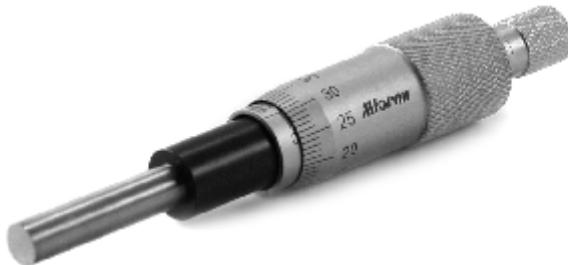
Головки микрометрические типа МГ предназначены для измерения перемещения с высокой точностью. Головка встраивается в ручные и стационарные измерительные приборы и измерительные средства. Устанавливаются и фиксируются в цилиндрическом отверстии. Гладкий выдвижной шток - с плоской пяткой, оснащен твердым сплавом. Без блокировки шпинделя. Присоединительные размеры: диаметр 12h7, длина 17 мм. Диаметр выдвижного штока 6,5 мм. Вылет штока от 3 до 28 мм. Общая длина 115 мм.
