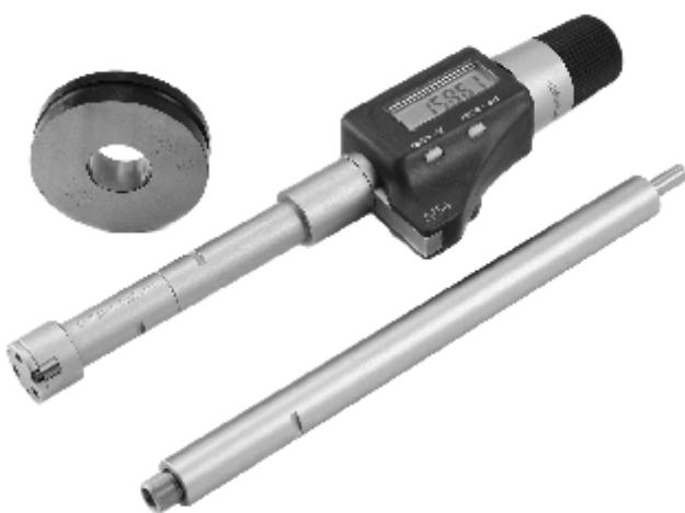
Нутромеры трехточечные электронные типа НМТЦ с реализованной с помощью цифрового индикатора системы считывания значений. Предназначены для особо точных измерений проходных, глухих отверстий, центрирующих кромок. Головка - самоцентрирующаяся. Измерительные щупы упрочнены твердым сплавом. Могут применяться для абсолютных и относительных измерений. В комплект поставки входят удлинитель, установочное кольцо, алюминиевый кейс.
