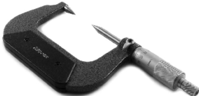
Микрометры с точечными измерительными поверхностями типа МК-ТП предназначены для измерения пазов и шлицев, шпоночных канавок, имеющих угловую форму, и других труднодоступных для измерения мест (измерение толщины втулки с внутренней резьбой). Особенно подходят для измерения мелких деталей благодаря малым измерительным поверхностям. Измерительные поверхности микрометра сужаются под углом 30° до толщины 0,3 мм, оснащены твердым сплавом.
