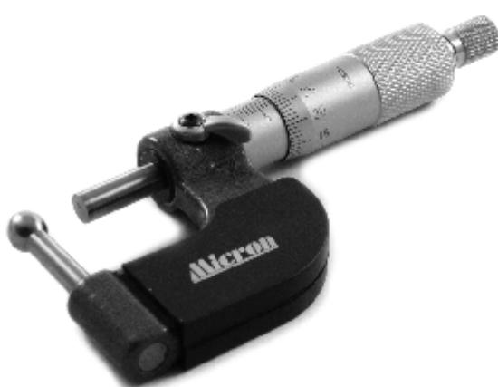
Микрометрами трубными типа МТ измеряют толщину стенок труб. Измерительная поверхность пятки выполнена в виде стержня со сферой, диаметром 4,7 мм, расположенного перпендикулярно перемещению стебля микрометрической головки. Измерительные поверхности оснащены твердым сплавом.
