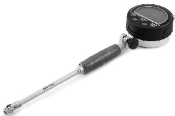
Нутромеры индикаторные электронные типа НИЦ предназначены для измерения внутренних размеров изделий двухточечным контактом с измеряемыми поверхностями относительным методом. Отсчетное устройство - электронный цифровой индикатор. На измерение требуемого размера нутромер настраивается с помощью одного из входящих в комплект сменных стержней. Настройка производится по аттестованным кольцам или блокам концевых мер длины с боковиками.
