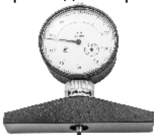
Глубиномеры индикаторные типа ГИ предназначены для измерения глубины пазов, отверстий и высоты уступов. Диапазон измерения обеспечивает набор сменных измерительных стержней, оснащенных твердым сплавом. Отчет - по индикатору.
