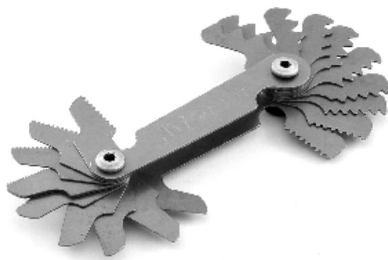
Шаблоны резьбовые предназначены для определения nominalного шага метрической резьбы (набор M 60°) и числа ниток (витков резьбы) на один дюйм (набор D 55°). Изготавливаются три набора резьбовых шаблонов. Конструкция обоймы набора обеспечивает возможность свободной замены любого шаблона, а также регулирование плавности вращения их на оси.
