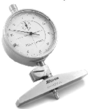
Глубиномеры индикаторные типа ГИ предназначены для измерения глубины пазов, отверстий и высоты уступов. Оснащены индикатором часового типа. Диапазон измерения обеспечивает набор сменных измерительных стержней, оснащенных твердым сплавом. У ГИ-100 девять стержней, у ГИ-150 четырнадцать стержней.
