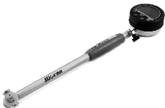
Нутромеры индикаторные электронные повышенной точности типа НИЦ-ПТ предназначены для измерения внутренних размеров изделий двухточечным контактом с измеряемыми поверхностями относительным методом. Отсчетное устройство - электронный цифровой индикатор. На измерение требуемого размера нутромер настраивается с помощью одного из входящих в комплект сменных стержней. Настройка производится по аттестованным кольцам или блокам концевых мер длины с боковиками.
