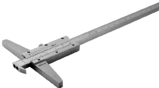
Штангенглубиномером типа ШГС можно производить измерения расположения труднодоступных канавок, других толщин, невозможные ординарным инструментарием. Шкалы штанги и нониуса имеют матовое хромовое покрытие, исключающие блики.
