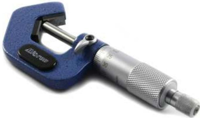
Призматические микрометры служат для измерения наружного диаметра многолезвийного инструмента, а именно: модель МПИ с углом призмы  $108^\circ$  - для пятилезвийного инструмента. В комплект микрометра входит установочная мера. Измерительные поверхности оснащены твердым сплавом.
