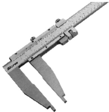
Штангенциркули с отсчетом по нониусу типа ШЦ-3 предназначены для наружных и внутренних измерений. Имеют устройство тонкой подачи. Имеют двойную шкалу: в миллиметрах и дюймах. Имеют губки с плоскими и цилиндрическими измерительными поверхностями для измерения наружных и внутренних размеров соответственно. Длина основных губок может быть разная в зависимости от модификации.
