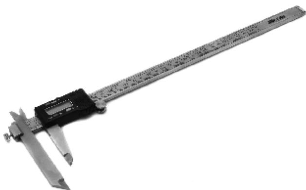
Штангенциркули типа ШЦЦ-У с цифровым отсчетом (электронные) с разновысотными губками предназначены для измерения толщины уступов и расстояния между ними. Губка измерительной штанги имеет возможность перемещаться и неподвижно фиксироваться параллельно измерительной губке подвижной каретки. Прибор имеет возможность установки «0» в любой позиции, переключение на метрическую или дюймовую систему, а также вывод информации через интерфейс.
