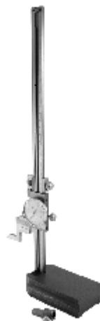
Штангенирмасы типа ШРК предназначены для выполнения измерений и разметки различных деталей в машиностроении. Штанга прибора имеет миллиметровую шкалу. Отсчет показаний производится по круговой шкале индикатора. Оснащены устройством тонкой подачи. Сменная измерительная/разметочная ножка оснащена твердым сплавом.
