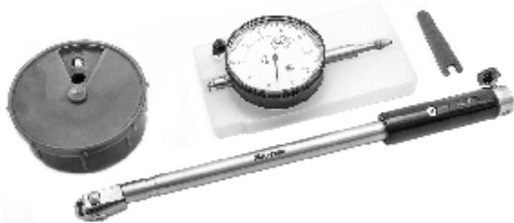
Нутромеры индикаторные типа НИ используются для определения внутренних размеров изделия. В качестве отсчетного устройства используется индикатор часового типа. На требуемый размер инструмент устанавливают при помощи сменных измерительных стержней (шайб, удлинителя) по аттестованным кольцам или по блоку мер длины с боковинами.
