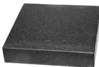
Плиты поверочные гранитные служат для проверки плоскости поверхностей по методу "пятен на краску" и "линейных отклонений" и используются в качестве вспомогательного приспособления при поверочных и контрольных работах. Изготавливаются 0 и 00 классов точности с шаброванной рабочей поверхностью.
