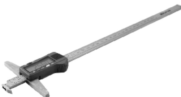
Штангенглубинометром типа ШГЦС можно производить измерения расположения труднодоступных канавок, других толщин, невозможные ординарным инструментарием. Отсчет показаний осуществляется по цифровой шкале. Цифровой блок позволяет устанавливать ноль в любом положении.
