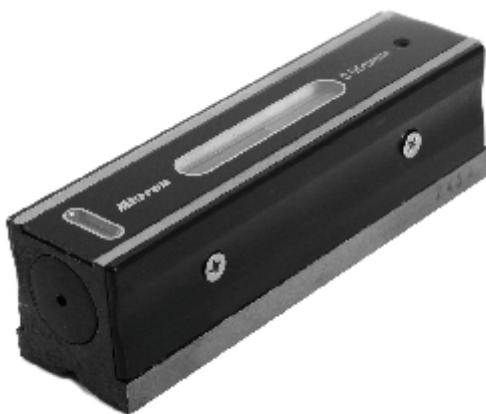
Уровни брусковые предназначены для контроля горизонтального расположения поверхностей, а также прямолинейности и плоскости горизонтально расположенных плоских и цилиндрических поверхностей с высокой точностью. Отсчет - по штрихам ампулы. Устройство выставления на ноль. Опорная поверхность изготовлена в виде призмы.
