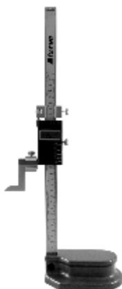
Штангенрейсмасы типа ШРЦ предназначены для выполнения измерений и разметки различных деталей в машиностроении. Штанга прибора имеет миллиметровую шкалу. Отсчет показаний производится по электронному цифровому индикатору. Оснащены устройством тонкой подачи. Сменная измерительная/разметочная ножка оснащена твердым сплавом.
