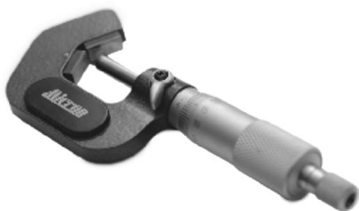
Призматические микрометры служат для измерения наружного диаметра многолезвийного инструмента, а именно: модель МСИ с углом призмы 128° - для семилезвийного инструмента. В комплект микрометра входит установочная мера. Измерительные поверхности оснащены твердым сплавом.
