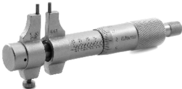
Нутромеры с боковыми губками предназначены для измерений внутренних размеров в неглубоких отверстиях. Отсчет производится по шкалам стебля и барабана микрометрической головки. Цена деления 0,01 мм. Невращающийся шпиндель.
