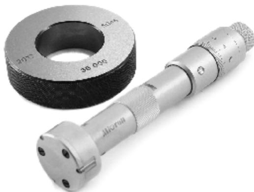
Нутромеры микрометрические трехточечные типа НМТ с реализованной с помощью микрометрической шкалы и стебля барабана системы считывания значений. Нутромеры цангового типа предназначены для особо точных измерений проходных, глухих отверстий, центрирующих кромок. Головка - самоцентрирующаяся. Измерительные щупы упрочнены твердым сплавом. В комплект поставки входят удлинитель, установочное кольцо, алюминиевый кейс.
