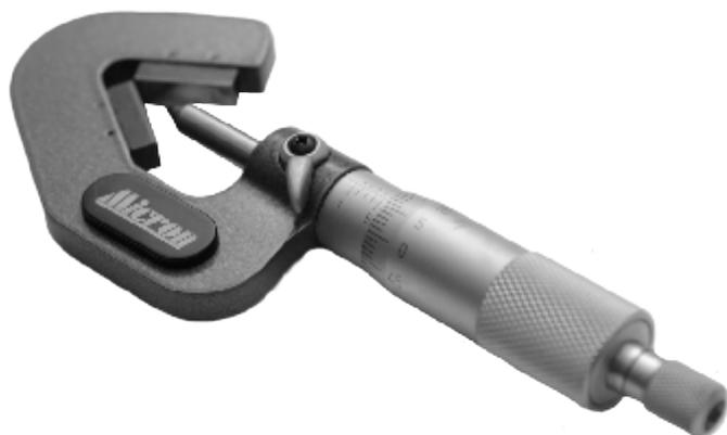
Призматические микрометры служат для измерения наружного диаметра многолезвийного инструмента, а именно: модель МТИ с углом призмы 60° - для трехлезвийного инструмента. В комплект микрометра входит установочная мера. Измерительные поверхности оснащены твердым сплавом.
