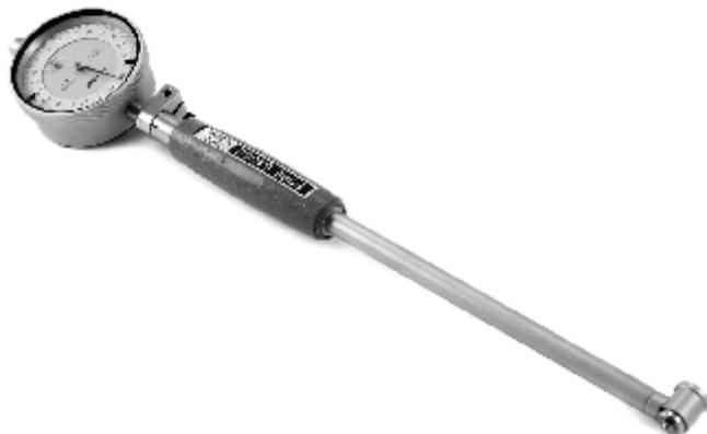
Нутромеры индикаторные повышенной точности типа НИ-ПТ предназначены для измерения внутренних размеров изделий двухточечным контактом с измеряемыми поверхностями относительным методом. Отсчетное устройство - индикатор часового типа. На измерение требуемого размера нутромер настраивается с помощью одного из входящих в комплект сменных стержней. Настройка производится по аттестованным кольцам или блокам концевых мер длины с боковинками.
