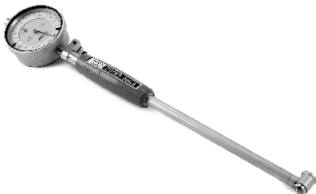
Нутромеры индикаторные повышенной точности типа НИ-ПТ предназначены для измерения внутренних размеров изделий двухточечным контактом с измеряемыми поверхностями относительным методом. Отсчетное устройство - индикатор часового типа. На измерение требуемого размера нутромер настраивается с помощью одного из входящих в комплект сменных стержней. Настройка производится по аттестованным кольцам или блокам концевых мер длины с боковиками.
