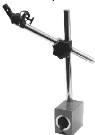
Штатив для измерительных головок типа ШМ-II-Н имеет магнитное основание и низкую колонку, используется для измерительных головок с ценой деления 0,01мм и более. Включение/выключение магнита осуществляется поворотом ручки. По цилиндрической колонке движется муфта со стержнем с закрепленной на конце измерительной головкой. Штатив имеет устройство для точной установки на размер.
