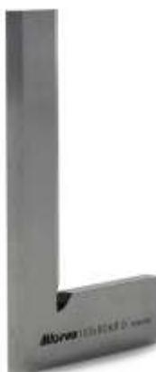
Угольники поверочные лекальные плоские типа УЛП предназначены для проверки прямых углов ( $90^\circ$ ) и применяются при слесарно-сборочных и лекальных работах для контроля взаимно перпендикулярного расположения деталей с высокой точностью. Имеют острые измерительные поверхности и плоские опорные поверхности.
