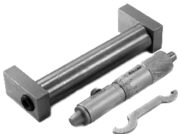
Нутромеры микрометрические узкодиапазонные типа НМ-У предназначены для измерения внутренних размеров изделий. В отличие от обычных микрометрических нутромеров, настраиваемых на необходимый диапазон с помощью соответствующих удлинителей, исполнение данных - штучное. Отсчет производится по шкалам стебля и барабана микрометрической головки. Измерительные поверхности притёрты по сфере. В комплект входит установочная мера.
