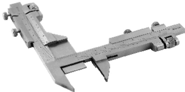
Штангензубомеры типа ШЗН предназначены для измерения толщины зуба зубчатого колеса на расчетной глубине и представляют собой сочетание штангеглубиномера и штангенциркуля. Вертикальная линейка штангензубомера предназначена для установки высоты от вершины зуба, на которой производится измерение толщины зуба, а горизонтальное устройство предназначено для непосредственного измерения толщины зуба. Штангензубомер может быть использован для измерения толщины зуба колес с модулем до 26.
