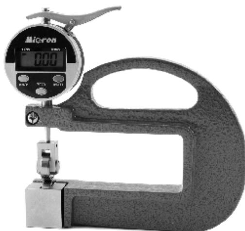
Толщиномеры роликовые ручные с цифровым индикатором типа ТРЛЦ предназначены для непрерывного контроля толщины листовых материалов, стали, бумаги, полимерных пленок и других листовых движущихся материалов. Их конструкция аналогична конструкции индикаторных моделей, с тем лишь отличием, что на измерительном стержне вместо пятки установлены ролики. Глубина скобы 100мм. Электронный индикатор с диапазоном 0-10 мм и ценой деления 0,01.
