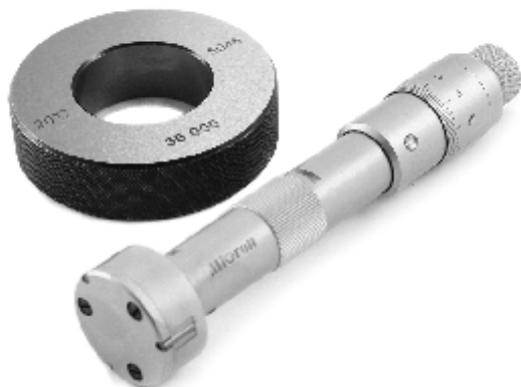
Нутромеры микрометрические трёхточечные типа НМТ с реализованной с помощью микрометрической шкалы и стебля барабана системы считывания значений. Нутромеры цангового типа предназначены для особо точных измерений проходных, глухих отверстий, центрирующих кромок. Головка - самоцентрирующаяся. Измерительные щупы упрочнены твердым сплавом. В комплект поставки входят удлинитель, установочное кольцо, алюминиевый кейс.
