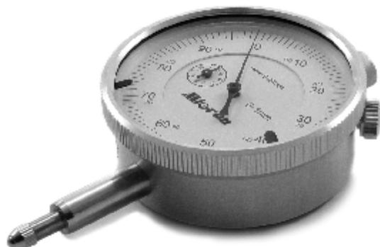
Индикатор часового типа с диапазоном измерения от 0 до 1 мм. Цена деления 0,001 мм. Позволяет выполнить специальные высокоточные измерения при использовании обычных для ИЧ способов крепления.
