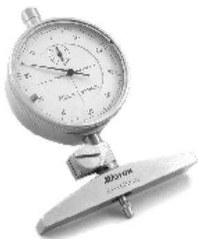
Глубиномеры индикаторные типа ГИ предназначены для измерения глубины пазов, отверстий и высоты уступов. Оснащены индикатором часового типа. Диапазон измерения обеспечивают набор сменных измерительных стержней, оснащенных твердым сплавом. У ГИ-100 девять стержней, у ГИ-150 четырнадцать стержней.
