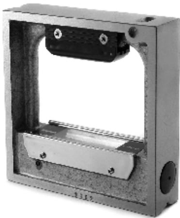
Уровни рамные предназначены контроля горизонтального и вертикального расположения поверхностей, а также прямолинейности и плоскости горизонтально расположенных плоских и цилиндрических поверхностей с высокой точностью. Рабочие поверхности изготовлены в виде призмы, позволяющей надежно устанавливать уровень на плоских и цилиндрических поверхностях. Отсчет - по штрихам ампул. Устройство установки на ноль.
