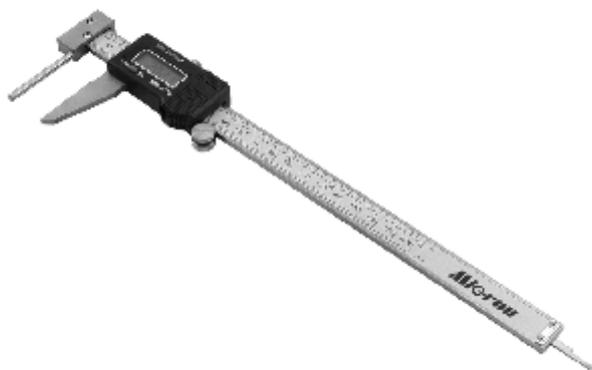
Штангенциркули типа ШЦЦ-Т с цифровым отсчетом (электронные) трубные предназначены для измерения толщины стенок труб. Прибор имеет возможность установки «0» в любой позиции, переключение на метрическую или дюймовую систему.
