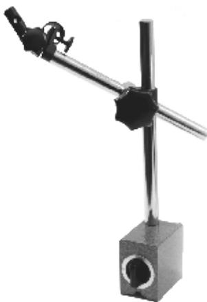
Штатив для измерительных головок типа ШМ-II-H имеет магнитное основание и низкую колонку, используется для измерительных головок с ценой деления 0,01мм и более. Включение/выключение магнита осуществляется поворотом ручки. По цилиндрической колонке движется муфта со стержнем с закрепленной на конце измерительной головкой. Штатив имеет устройство для точной установки на размер.
