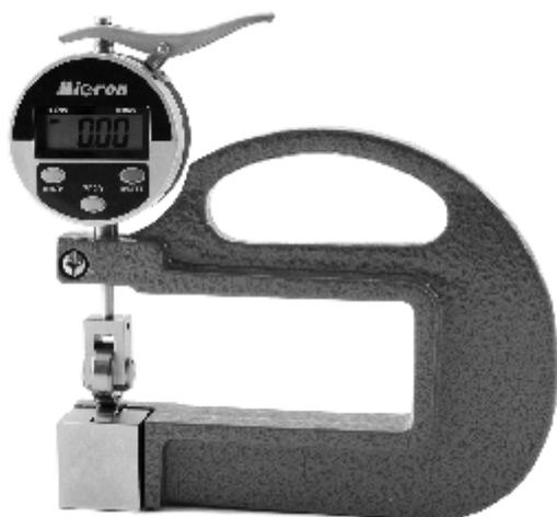
Толщиномеры роликовые ручные с цифровым индикатором типа ТРЛЦ предназначены для непрерывного контроля толщины листовых материалов, стали, бумаги, полимерных пленок и других листовых движущихся материалов. Их конструкция аналогична конструкции индикаторных моделей, с тем лишь отличием, что на измерительном стержне вместо пятки установлены ролики. Глубина скобы 100мм. Электронный индикатор с диапазоном 0-10 мм и ценой деления 0,01.
