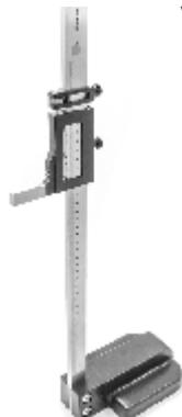
Штангенрейсмасы типа ШР предназначены для измерения линейных размеров и разметки. Штанга прибора имеет миллиметровую шкалу. Отсчет показаний производится по нониусу. Рамка нониуса оснащена устройством тонкой настройки для облегчения установки на требуемый размер.
