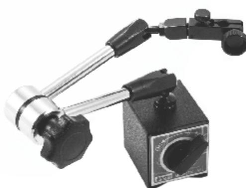
Стойка типа МСШ предназначена для установки на ней измерительных головок с ценой деления 0,01 мм и контролируемым изделием. Особенностью конструкции стойки является наличие шарниров которые обеспечивают семь степеней свободы. Магнитное основание позволяет устанавливать стойку на наклонных и вертикальных плоскостях без дополнительного крепления, а призматическая выемка на нижней поверхности, позволяет закреплять ее на цилиндрических поверхностях. Оснащена устройством микрорегулирования.
