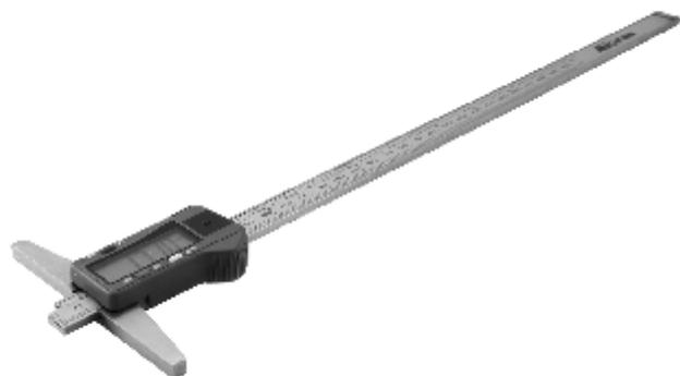
Штангенглубиномер с цифровым индикатором типа ШГЦ предназначен для измерения глубин. Оснащен цифровым индикатором, с помощью которого быстро и удобно снимать показания. Электронный блок позволяет производить переключения систем измерения мм/дюйм, выставлять нулевое значение в любом желаемом месте.
