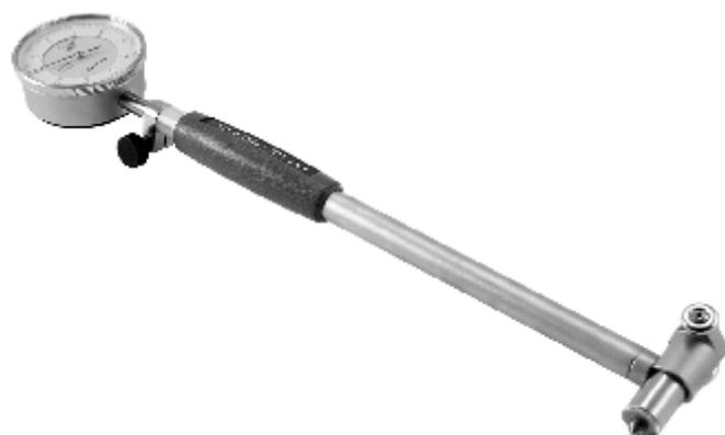
Нутромеры индикаторные типа НИ предназначены для измерения внутренних размеров изделий двухточечным контактом с измеряемыми поверхностями относительным методом. Отсчетное устройство - индикатор часового типа. На измерение требуемого размера нутромер настраивается с помощью одного из входящих в комплект сменных стержней. Настройка производится по аттестованным кольцам или блокам концевых мер длины с боковиками.
