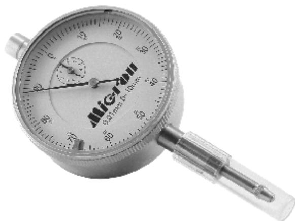
Индикатор часового типа ИЧ предназначен для измерения линейных размеров как абсолютным, так и относительным методами, а также определения величины отклонений от заданной геометрической формы и взаимного расположения поверхностей. Для крепления индикаторов в стойках или посадочных местах измерительных приборов предназначены присоединительная гильза диаметром 8h7 или ушко толщиной 5 мм с отверстием диаметром 5 мм.
