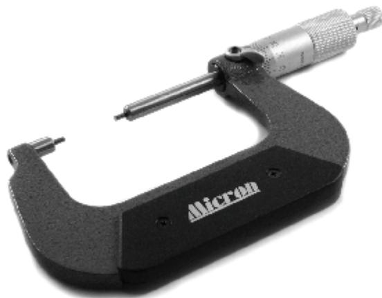
Микрометры с малыми измерительными поверхностями типа МК-МП предназначены для измерения пазов и шлицев, шпоночных канавок и других труднодоступных для измерения мест. Особенно подходят для измерения мелких деталей благодаря малым измерительным поверхностям. Диаметр измерительных поверхностей 3 мм, они оснащены твердым сплавом.
