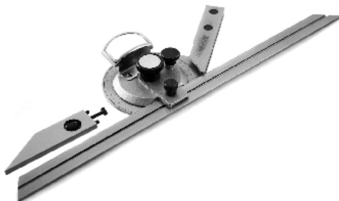
Угломеры нониусные с лупой предназначены для измерения наружных и внутренних углов. Технические характеристики: Диапазон измерения -наружных углов: 0-360° (4x90°), -внутренних углов 0-270°; Значение отсчета: -по основной шкале 1°, -по нониусу 5'; Длина основной шины: 150мм (200, 300). Оснащены дополнительной линейкой и увеличительной лупой для облегчения снятия показаний. Точная установка облегчает установку на желаемый угол. Запорное устройство против нежелательной переустановки.
