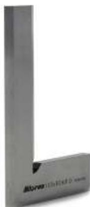
Угольники поверочные лекальные плоские типа УЛП предназначены для проверки прямых углов (90°) и применяются при слесарно-сборочных и лекальных работах для контроля взаимно перпендикулярного расположения деталей с высокой точностью. Имеют острые измерительные поверхности и плоские опорные поверхности.
