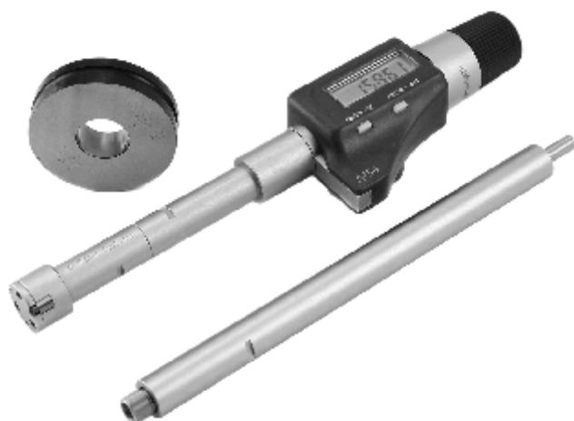
Нутромеры трёхточечные электронные типа НМТЦ с реализованной с помощью цифрового индикатора системы считывания значений. Предназначены для особо точных измерений проходных, глухих отверстий, центрирующих кромок. Головка - самоцентрирующаяся. Измерительные щупы упрочнены твердым сплавом. Могут применяться для абсолютных и относительных измерений. В комплект поставки входят удлинитель, установочное кольцо, алюминиевый кейс.
