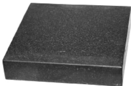
Плиты поверочные гранитные служат для проверки плоскостности поверхностей по методу "пятен на краску" и "линейных отклонений" и используются в качестве вспомогательного приспособления при поверочных и контрольных работах. Изготавливаются 0 и 00 классов точности с шаброванной рабочей поверхностью.
