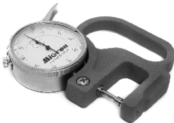
Толщиномеры ручные типа ТР с нормированным измерительным усилием предназначены для измерения толщины тонких/листовых материалов. Считывание показаний производится по многооборотному индикатору часового типа. Цена деления 0,01 мм. Диапазон измерений 0-10 мм. Вылет корпуса 30, 60 или 120 мм (зависит от исполнения).
