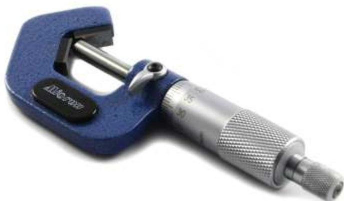
Призматические микрометры служат для измерения наружного диаметра многолезвийного инструмента, а именно: модель МПИ с углом призмы 108° - для пятилезвийного инструмента. В комплект микрометра входит установочная мера. Измерительные поверхности оснащены твердым сплавом.
